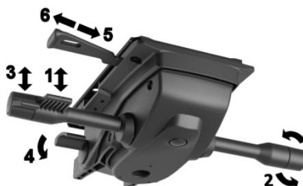
**Sitzhöhenverstellung:** Ziehen Sie den rechten Hebel nach oben, um den Kolben zu lösen, und lassen Sie ihn in der gewünschten Höhe los, um die Position zu arretieren (siehe 1).
