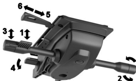
**Ovládání výšky sedáku:** tahem pravé páky směrem vzhůru odjistíme píst a uvolněním v žádané výšce polohu zajistíme (viz. 1).
