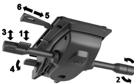
**Ovládanie výšky sedadla:** Ťahom pravej páčky smerom hore odistíme piest a uvoľnením v žiadanej výške polohu zabezpečíme (vid'. 1).
