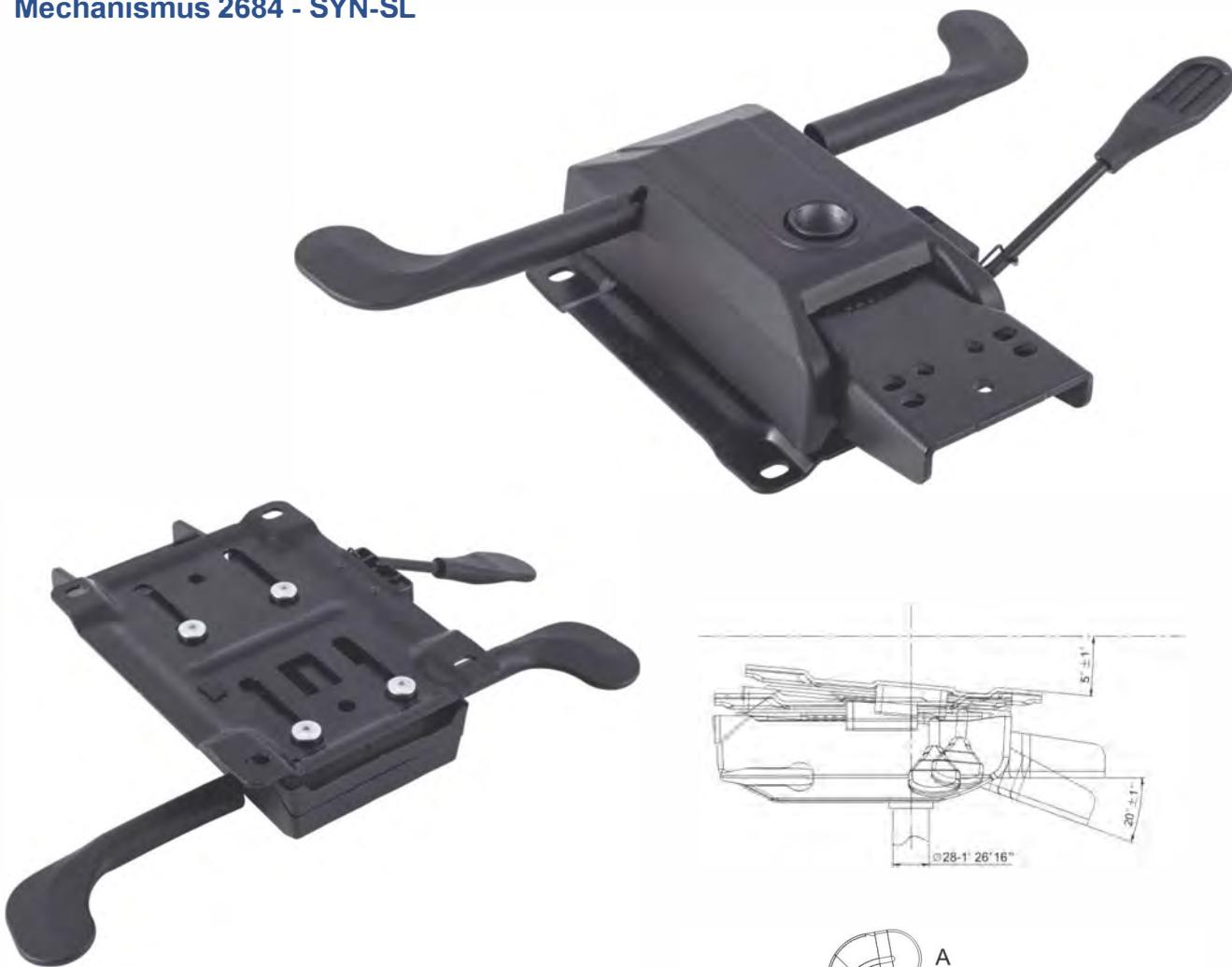
Synchronní mechanismus s automatickým nastavením síly protiváhy, s bezpečnostní funkcí zamezení návratu opěradla a 4 polohami pro aretaci; Páka A je pro nastavení výšky sedadla, páka B je pro pohyb sedadla a opěráku. Úhel sedadla je v rozsahu 0° -5,0° a úhel opěradla je 90° -110°. Páka G je pro pohyb posuvu hloubky sedadla v rozpětí 0-58 mm s 5 polohami aretace.
