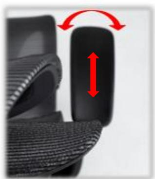
**Nastavení bederní opěry:** bederní opěra podporuje během sezení přirozené zakřivení páteře. Model KLEM umožňuje její vodorovné nastavení v rozsahu 0-65 mm. Směrem vpřed se posouvá pouze tahem opěráku za spodní část a polohy signalizuje zřetelné cvaknutí. Pro pohyb zpět se páka „4“ pootočí po směru hodinových ručiček v pohledu zleva, proti směru z pohledu zprava. Aretace se uvolní a opěrák se zasune do výchozí polohy.
